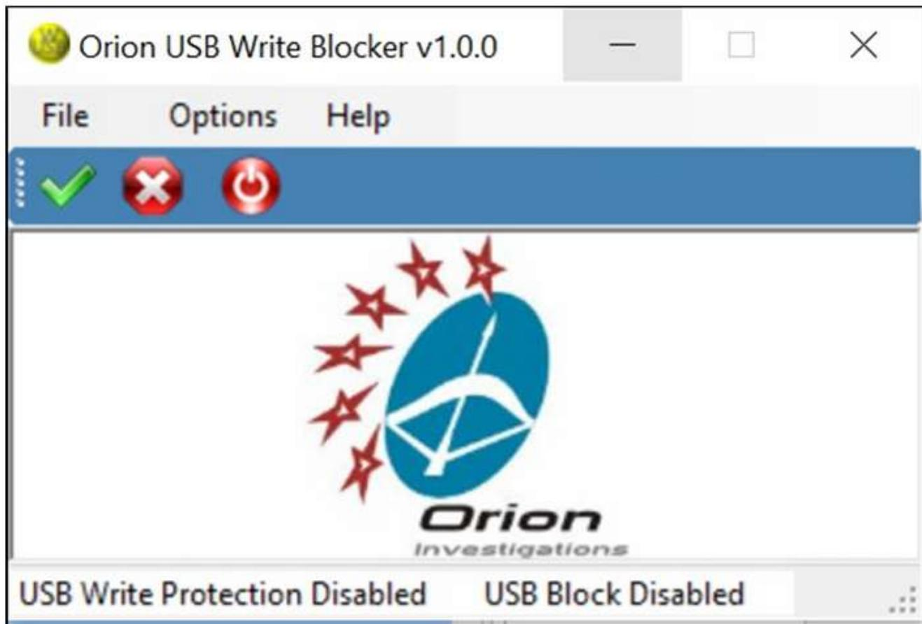
USB Write Blocker je digitalni forenzički alat dizajniran da spreči zapisivanje podataka na USB uređaje tokom istrage ili analize. U digitalnoj forenzici, očuvanje integriteta dokaza je ključno, a USB Write Blocker osigurava da se podaci sa USB uređaja (poput eksternih tvrdih diskova, USB fleš memorija i drugih prenosnih medija) mogu pregledati i analizirati bez rizika od slučajnog ili namernog menjanja. Evo glavnih primjena i funkcionalnosti USB Write Blockera:
